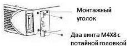
Рис.3 Установка монтажных уголков
