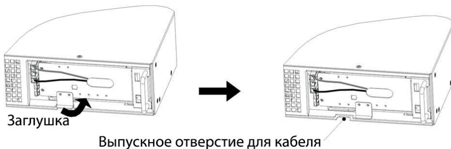
Рис. 6 а Удаление заглушки выпускного отверстия в ИБП.
